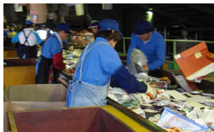
熊本市リサイクルセンターでの紙の選別作業の様子
